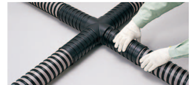
2.部品との接続 あらかじめ本管にソケットを取り付け、部品と合わせてソケットを戻して接続します。
