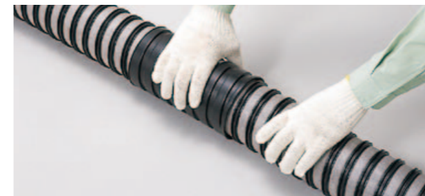
1.本管の接続 一方のパイプにソケットを全部ネジ込み、もう一方のパイプと合わせ、ほぼ中央になる様に戻します。
