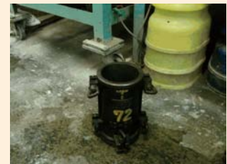
2分割式の鋼製型枠
